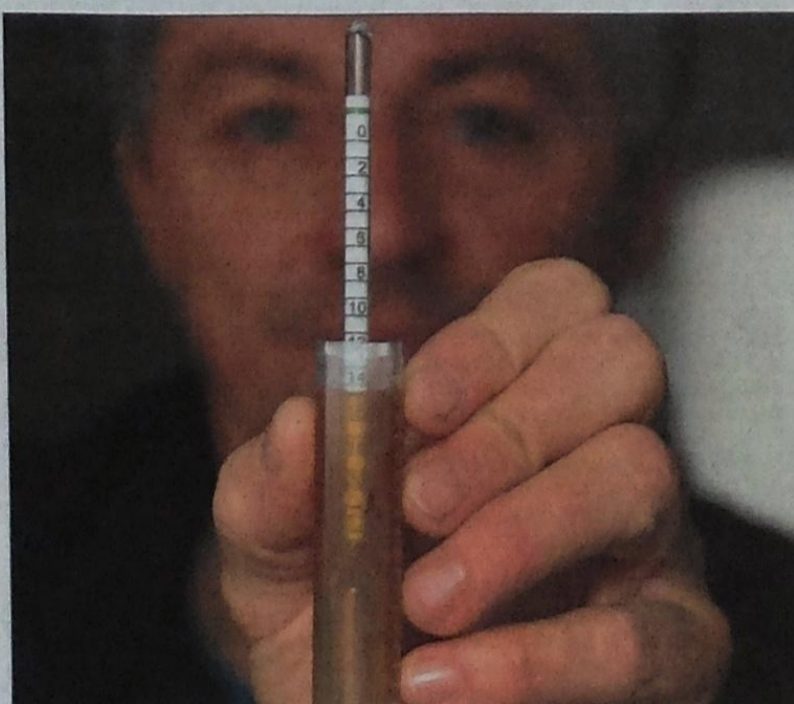
Mit der Bierspindel wird die Stammwürze gemessen. Sie entscheidet über den Alkoholgehalt, den das Bier am Ende haben wird.
